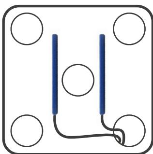
Wanneer het 3 in 1 systeem in de hydroponics modus wordt gebruikt kunnen de vier bruisstenen (**Q**) het best in de lekbak onder de netcups worden geplaatst volgens onderstaande schets. De luchtslangen kunnen via 1 van de plantgaten naar binnen worden geleid.
